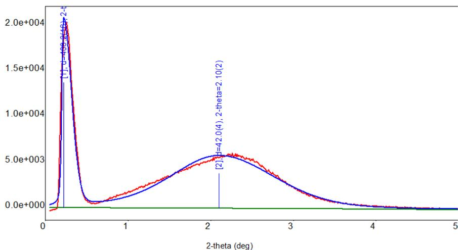
Рисунок 3 – Рентгенограмма малоуглового рассеяния мезопористого алюмосиликата Al-HMS
